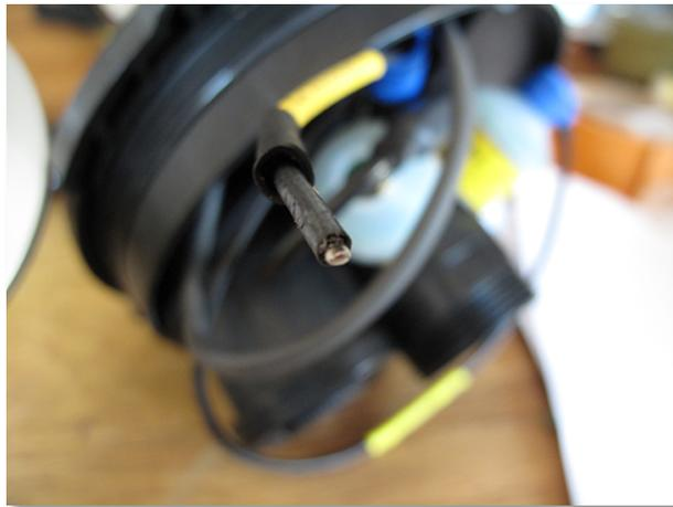
*Eliminer dans la mesure du possible la zone du câble coaxial en mauvais état (attention à la longueur).*
