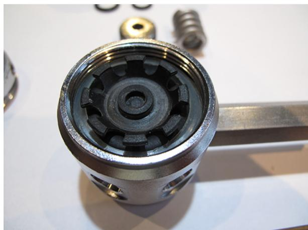
Monter la membrane, la rondelle et le support du ressort.
