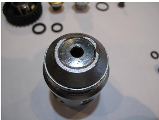
Serrer la vis de réglage de la MP jusqu'à affleurement.
