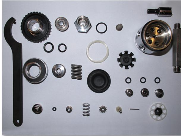
Détendeur démonté et entièrement nettoyé.
