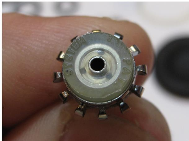
Assembler le clapet sur sa couronne.
