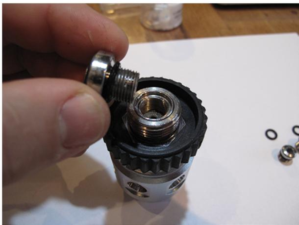
Monter le volant DIN après lubrification des joints.
