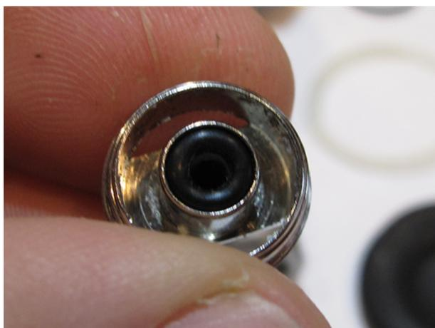
Graisser légèrement le joint avant montage.
