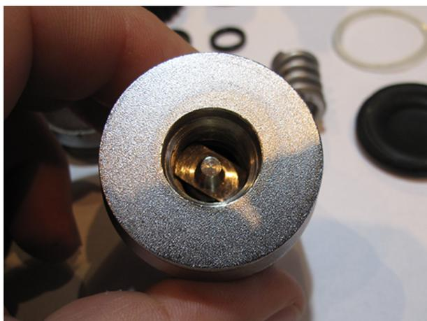
Monter l'ensemble dans le corps du 1er étage à l'aide d'une clé à douille de 10 préalablement limée.
