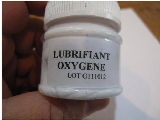
Utiliser de la graisse oxy pour la lubrification.
