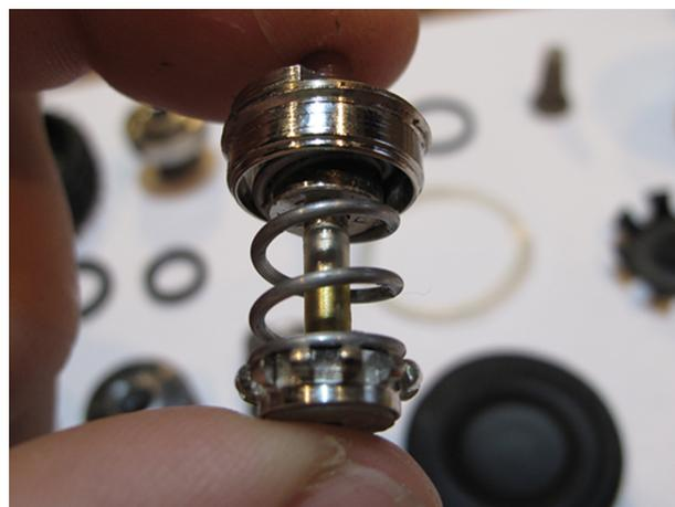
Assembler le clapet HP sur le ressort de compensation après montage du cache sur la vis de tension.
