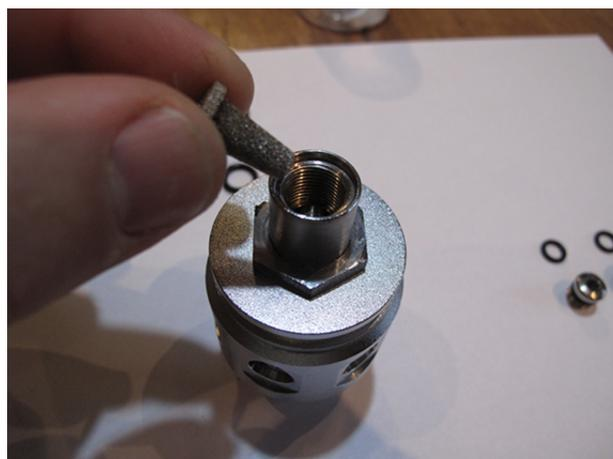
Monter le support du volant DIN après lubrification du joint, serrer modérément avec une clé de 22. Insérer le fritté.
